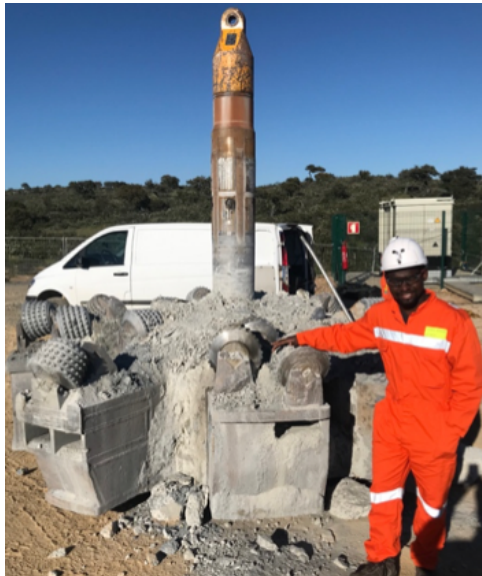
Figura 2.1: Reaming head da CPV23 de 4.1m de diâmetro
